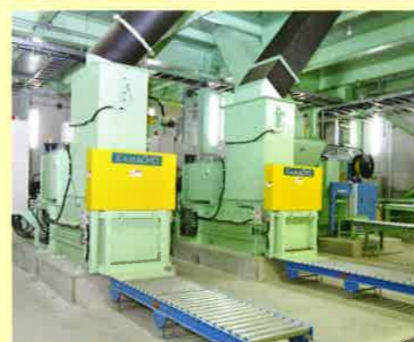
●スチール・アルミ缶プレス機 選別機で選別されたスチール缶、アルミ缶を圧縮成型します。
