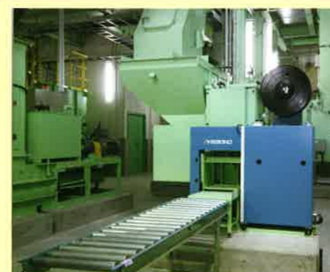
●ペットボトル圧縮・結束機 ペットボトルを圧縮・結束します。
