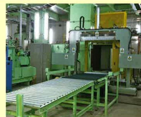
●プラスチック製容器包装圧縮・梱包機 異物除去したプラスチック製容器包装を圧縮・梱包します。
