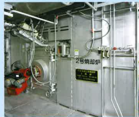
●焼却炉 炉に入ったごみは、850℃以上の高温で燃焼し、ごみの臭気成分さえも熱分解させます。
